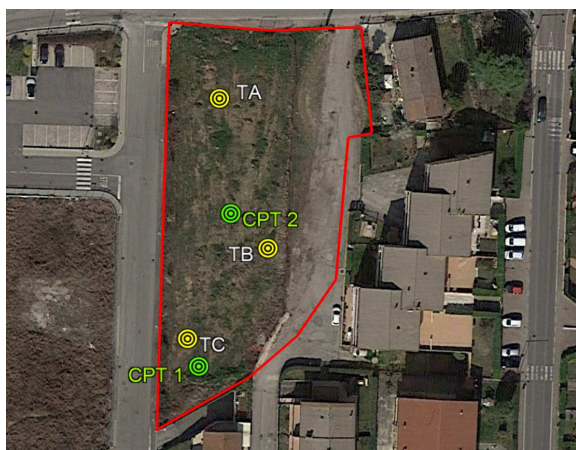
Figura 2. Ubicazione delle indagini eseguite nel sito in argomento: in verde, le prove penetrometriche statiche CPT e, in giallo, le trincee esplorative; in rosso, il perimetro del P.U.A. in progetto
