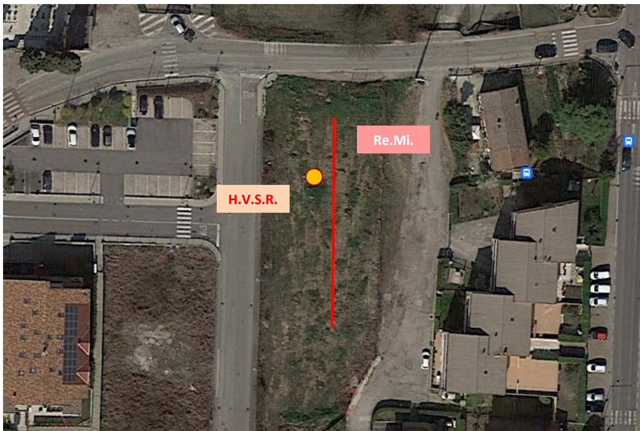
Fig. n° 2 - Ubicazione prove in sito e, sotto, viste del punto della prova H.V.S.R. (sinistra) e Re.Mi. (destra)
